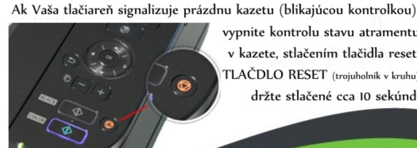
Ak Vaša tlačiareň signalizuje prázdnú kazetu (blikajúcou kontrolkou), vypnite kontrolu stavu atramentu v kazete, stlačením tlačidla reset. TLAČDLO RESET (trojuholník v kruhu) držte stlačené cca 10 sekúnd.
